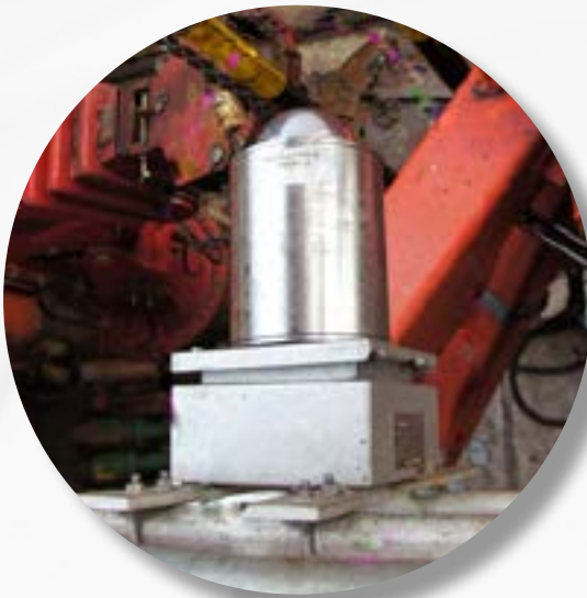
1. DATAEAGLE auf der Festseite im Ex-Schutzgehäuse.
